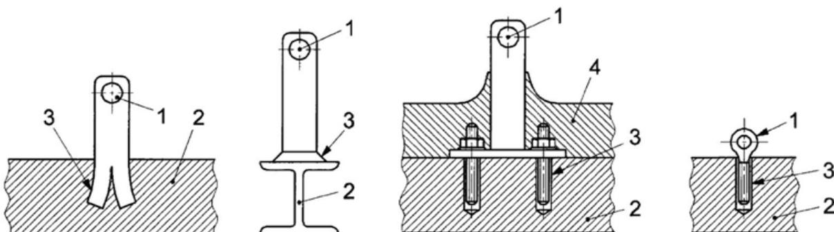
Quando il materiale base è a vista, come ad esempio travi di coronamento, parapetti e aggetti in cemento armato, coperture in lamiera, sarà indispensabile superare il pacchetto di copertura per individuare gli elementi strutturali in grado di assorbire i carichi determinati dall'arresto caduta.
