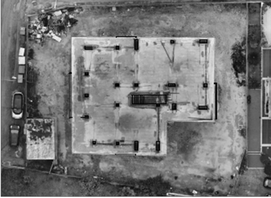
Figura 4 – Immagine laser-scanner di un edificio oggetto di un complesso intervento di adeguamento sismico
